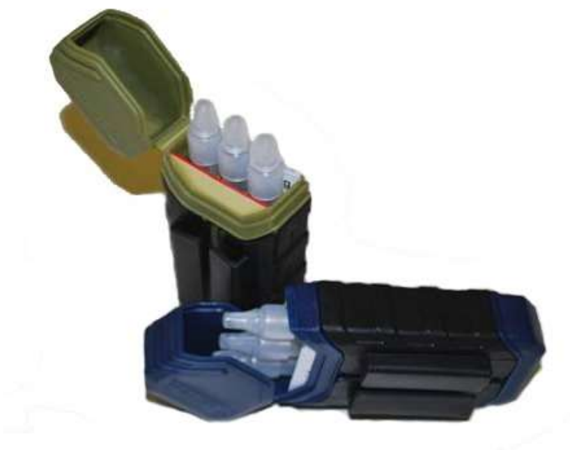
47. ábra: ExPen ampullás robbanóanyag kimutató reagens készlet
