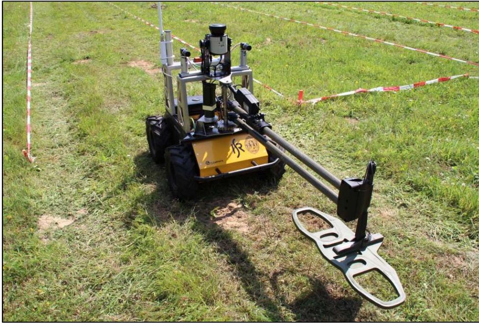
63. ábra: A TIRAMISU amerikai aknafelderítő robot
