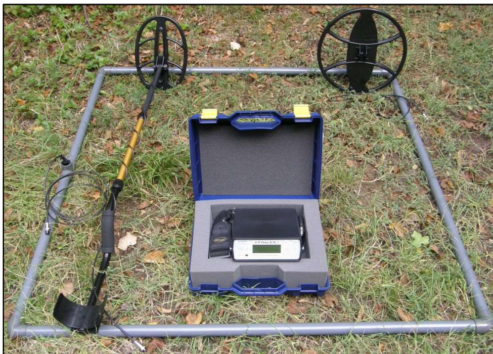
62. ábra. Impulzus üzemű fémkereső készlet
