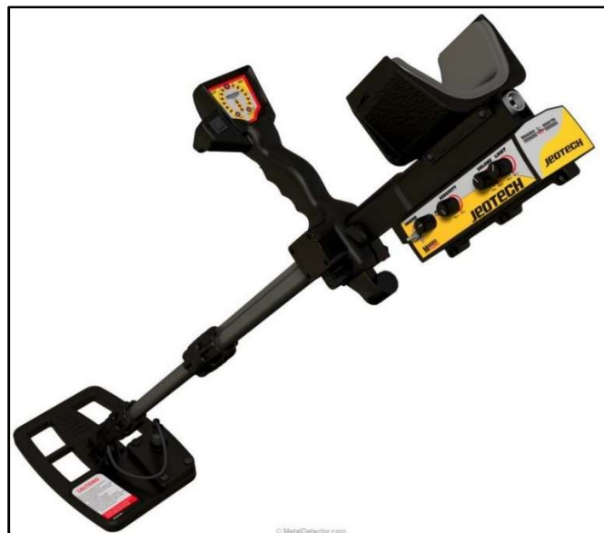
59. ábra. BFO-rendszerű fémkereső
