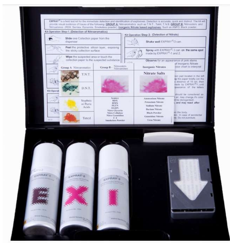
45. ábra: ExPray aeroszol alapú robbanóanyag kimutató reagens készlet
