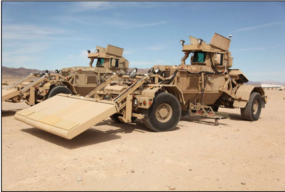
75. ábra: Husky páncélozott aknakutató gépjármű
