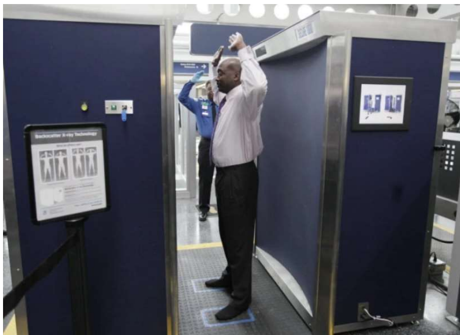
39. ábra: Teljes test-scanner alkalmazása egy kereskedelmi repülőtéren
